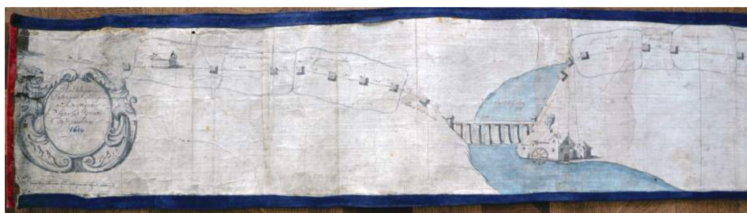
Plan (extrait) de la canalisation d'eau alimentant la pompe, 1610 (Arch. com. de Tréguier, 1 Fi 8) On reconnaît les arches de l'aqueduc qui existe toujours sur le Guindy.
